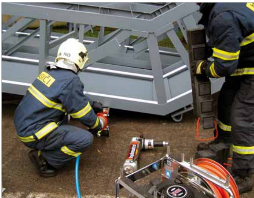
Použitie vyslobodzovacieho zariadenia (rozpínacie kliešte).
