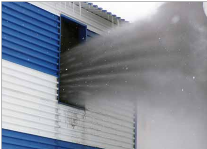
Spodiny horenia a vodná para sú vtáňované do vodného kužela.
