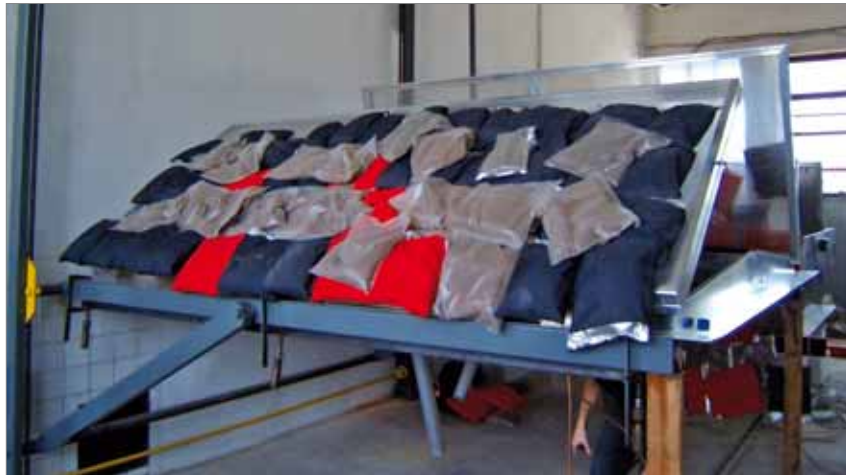
Skúška otvorenia dvojkrídlového zariadenia na odvod tepla a splodín horenia pri zaťažení snehom (závažia v podobe vriec s pieskom predstavujú sneh, ktorý pôsobí proti otváraniu krídel).
